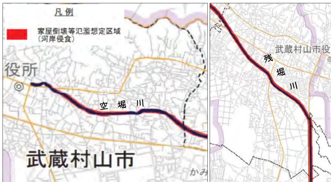
家屋倒壊等氾濫想定区域（河岸侵食）
