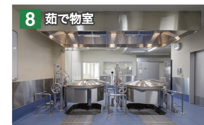
8 茹で物室 和え物調理前に野菜を茹でる専用室。煮炊き釜で大量の野菜を一度に茹でる事ができます。
