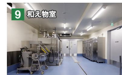
9 和え物室 室温を低く抑えて安全に和え物調理。専用の攪拌装置と移動釜を連結して食材を均等かつ衛生的に攪拌。従来の手による攪拌と比べて大幅な省力化を実現します。
