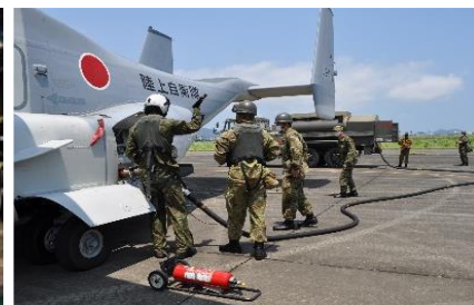
航空機への燃料補給・整備
