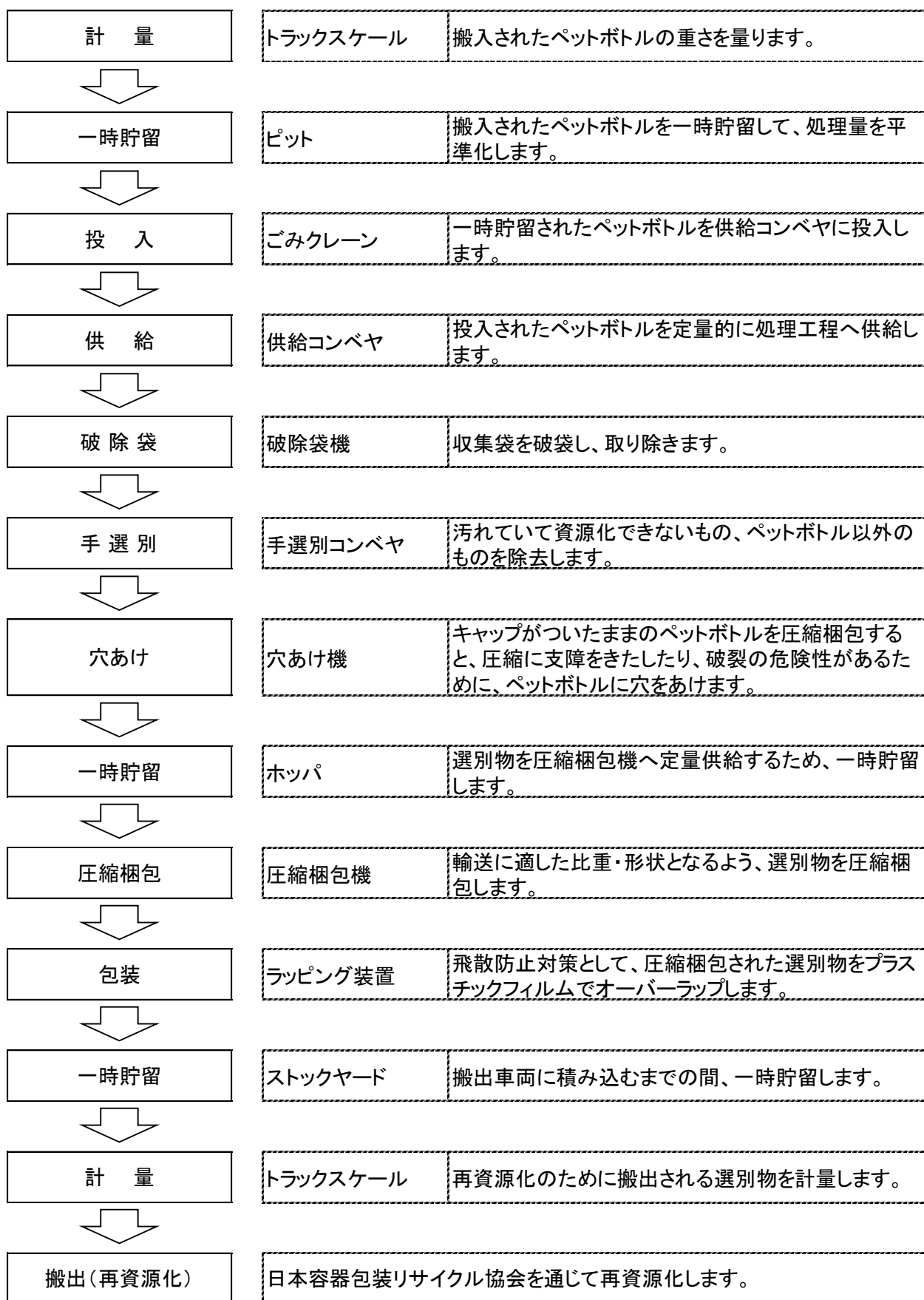
図 3-7 処理フロー（ペットボトル）
