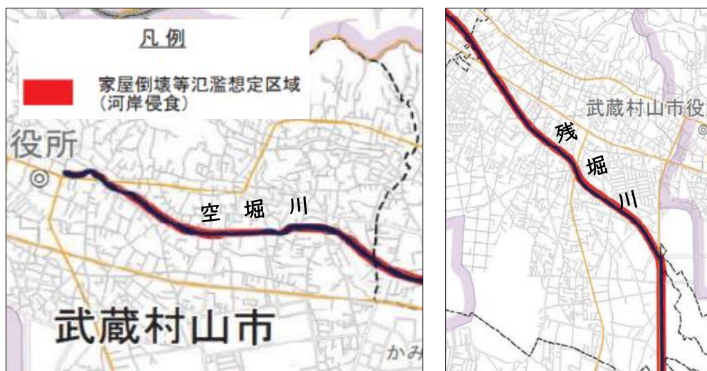
図 家屋倒壊等氾濫想定区域（河岸侵食）（出典：東京都建設局「洪水浸水想定区域図」（令和6年2月時点））
